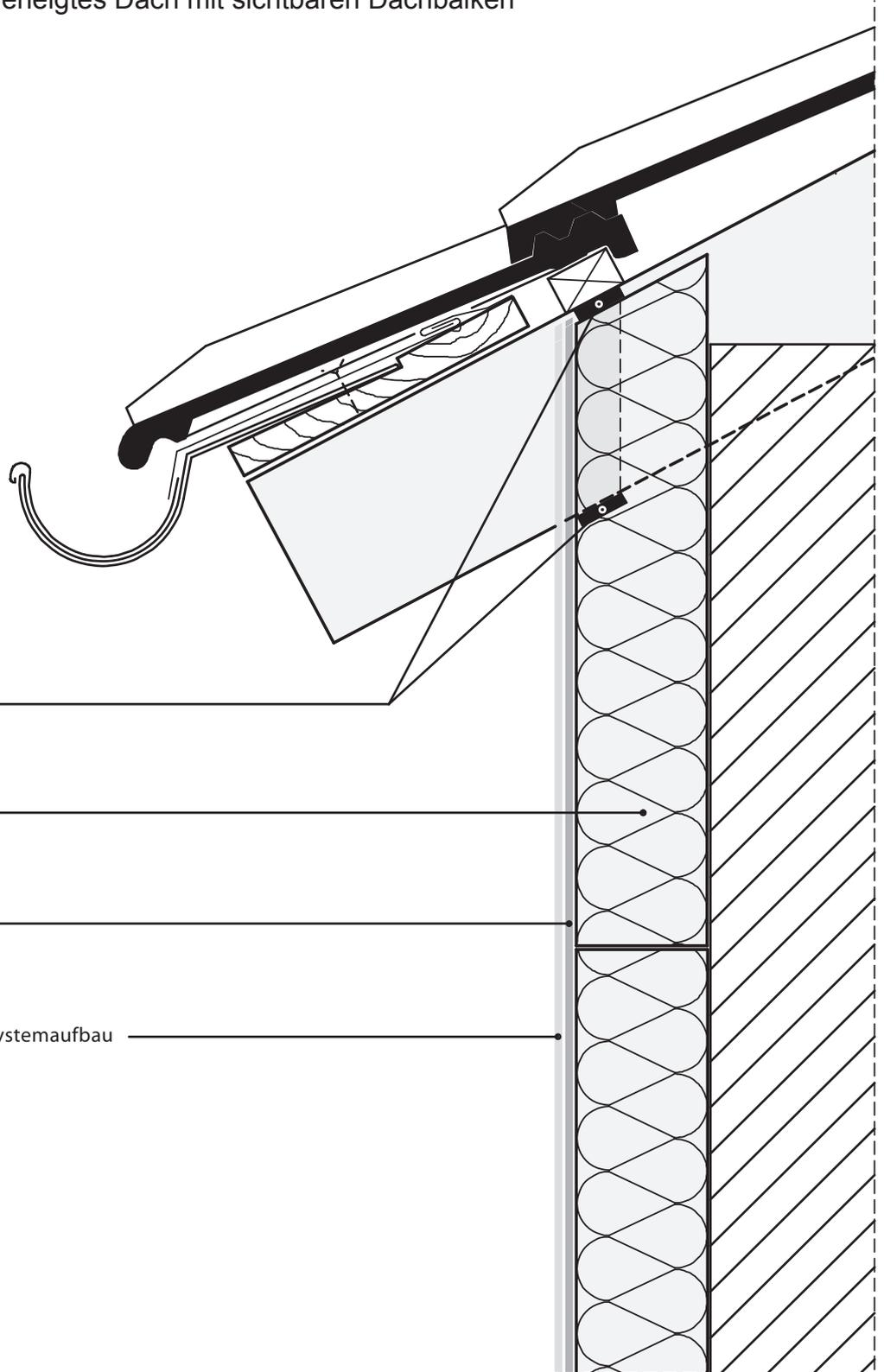
WDVS Dichtband, umlaufend
